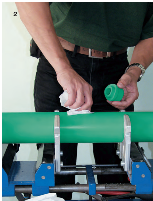
2 Pulire con apposito detergente per PPR e l'uso di un panno carta l'area interessata dalla saldatura ed asciugare.
